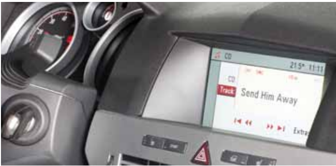
Nachrüstfeindlich: Beim Ausbau des Werksradios würden Informationen des Bordcomputers verloren gehen – also bleibt es drin.
