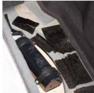
Raw Deluxe: Der Kondensator unter der Kofferraumabdeckung sorgt für konstante Spannung.
