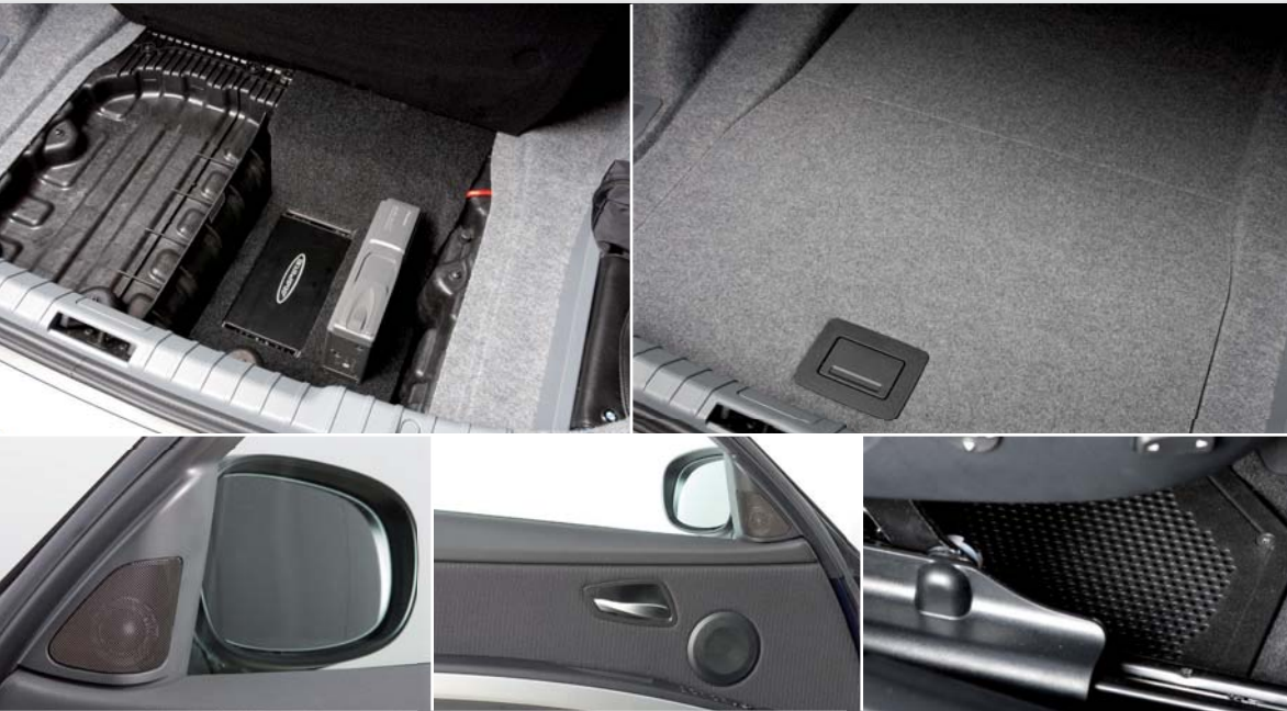
Hundertprozent alltagstauglich: Das Staufach im Kofferraumboden (oben links) ist dank Runflat-Reifen frei und beherbergt nun Verstärker und CD-Wechsler. Bei geschlossenem Deckel (oben rechts) ist davon rein gar nichts zu sehen. Auch Hochtöner (unten links), Mitteltöner (unten Mitte) und Subwoofer (unten rechts) verstecken sich unauffällig in den Werksöffnungen.
