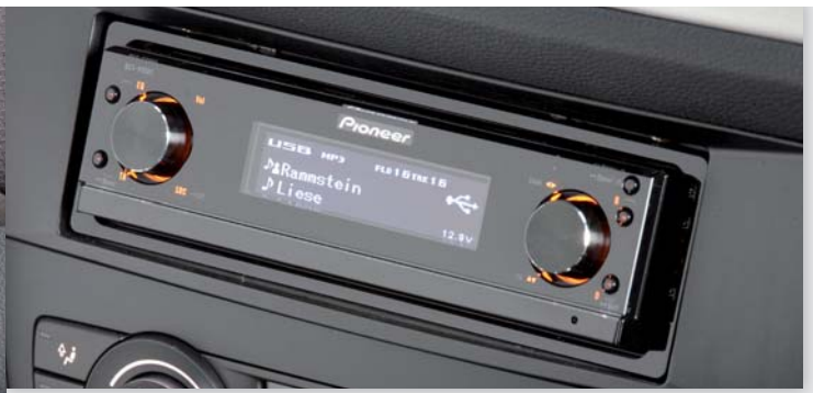
Black Beauty: Der edle und topmoderne CD-Tuner Pioneer DEX-P 99 RS (oben) verarbeitet zahlreiche Dateiformate und hat einen prall ausgestatteten Signalprozessor mit Equalizer, Laufzeitkorrektur und Weiche an Bord. Befehle erteilt der User auch per Fernbedienung (links).
